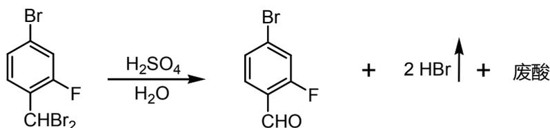
500L 反应釜中加入定量的 98%硫酸, 开动搅拌, 再加入定量工艺水; 控制 T=50℃~60℃, 向体系中缓慢滴加 4-溴-2-氟二溴苯, 控 50~60℃反应 20-24h, HPLC 检测无原料。体系降温至 T<60℃, 向体系中加水(析出固体), 控 T<20℃, 离心, 湿品烘干得产品。收率: 80%
