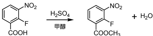
于洁净的 2000L 搪瓷釜中加入甲醇，搅拌下加入主原料，给体系升温至  $35 \sim 40^\circ\text{C}$ ，滴加硫酸；加完保持半小时后将体系升温至回流 ( $T=100^\circ\text{C}$ ) 保持反应 6-7h；反应结束体系常压浓缩出 600L 甲醇；降温至  $T < 30^\circ\text{C}$ ，转移至装有水的 2000L 釜中搅拌冰解 0.5h，离心得产品烘干。
